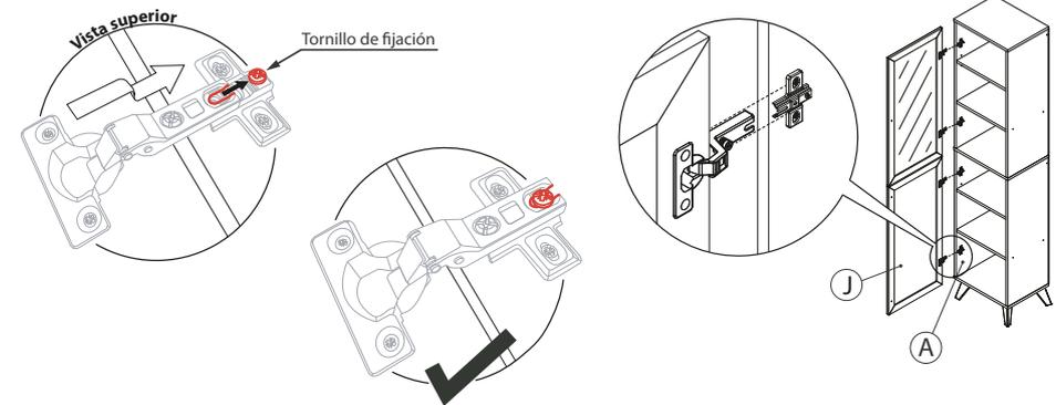
Así mismo, en la parte posterior de la bisagra, el **lado corto** debe ingresar en el **tornillo balancín** del **lado largo** como indica el gráfico.
