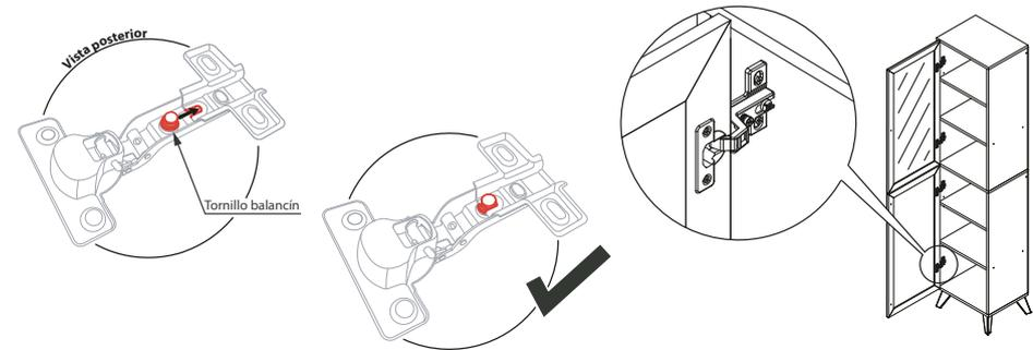
Cuando ambas partes coincidan ajustá el **tornillo de fijación** para ajustar los dos lados de la bisagra. Luego, repite los pasos con la otra puerta **I**.
