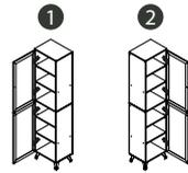
Toma las bisagras **T** y separalas entre sí, para tener un **lado largo** y un **lado corto**, luego atornilla el **lado corto** de las bisagras en ambos laterales **A** con los tornillos autopercantes **Y** en las posiciones indicadas en el gráfico. En caso de elegir la opción **2**, colocá las bisagras en los laterales **B**.
