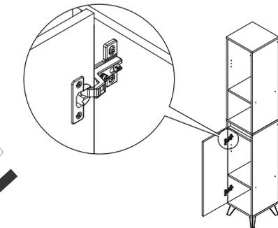
Cuando ambas partes coincidan ajustá el tornillo de fijación para ajustar los dos lados de la bisagra.
