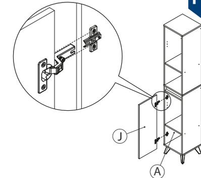
Así mismo, en la parte posterior de la bisagra, el lado corto debe ingresar en el tornillo balancín del lado largo como indica el gráfico.
