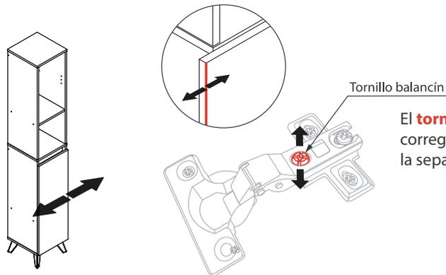
El **tornillo balancín** se utiliza para corregir el nivel de la puerta y/o la separación entre puertas.
