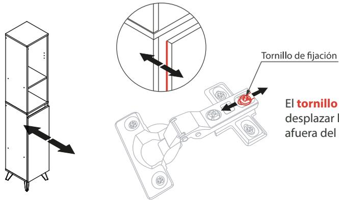
El **tornillo de fijación** se utiliza para desplazar la puerta hacia adentro o afuera del mueble.
