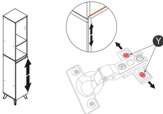
Los **tornillos Y** del lado corto de la bisagra se utilizan para regular la altura de la puerta hacia arriba o abajo.
