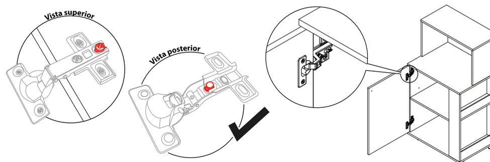
Cuando ambas partes coincidan ajustá el **tornillo de fijación** para fijar los dos lados de la bisagra.
