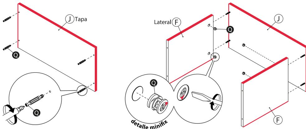
Fija la tapa (C) a los laterales (F) a través de las perforaciones pasantes mediante los tornillos (Z) utilizando la llave allen. Luego fija seis pernos minifix (Q) en las perforaciones no pasantes de la tapa (C) como indica el gráfico.
