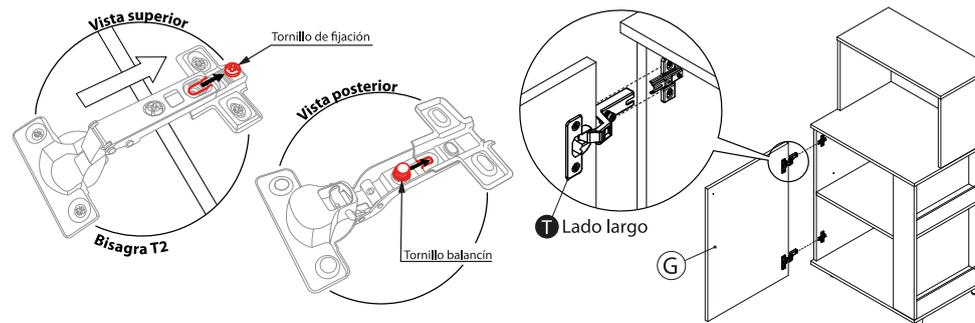
Así mismo, en la parte posterior de la bisagra, el **lado corto** debe ingresar en el **tornillo balancín** del **lado largo** como indica el gráfico.
