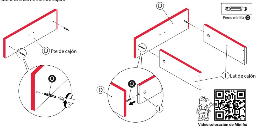
Luego, inserta las cajitas minifix ④ a los laterales de cajón ③ con la **flechita** orientada hacia los frentes de cajón. Una vez colocada la cajita, atornillala verificando que la flechita quede mirando al lado opuesto, como indica el **detalle minifix**.
