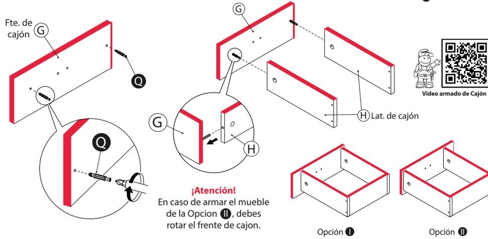
Luego, inserta las cajitas minifix **Q** a los laterales de cajón **H** con la **flechita** orientada hacia el frente de cajón **G**. Una vez colocada la cajita, atorníllala hasta que trabes.
