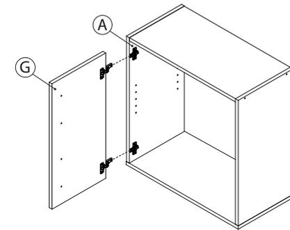
Así mismo, en la parte posterior de la bisagra, el **lado corto** debe ingresar en el **tornillo balancín** del **lado largo** como indica el gráfico.
