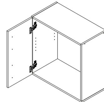
Cuando ambas partes coincidan ajustá el **tornillo de fijación** para ajustar los dos lados de la bisagra. Repetí el paso **9** para colocar la puerta restante.
