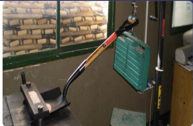
Después del ensayo, la empuñadura no habrá descendido más de 25mm y el mango permanecerá adherido a la vaina.
