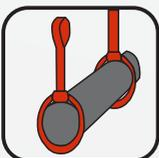
\* Las eslingas usadas en forma de lazo deberán tener la longitud optima para lograr la acción de estrangulación en la misma. El amarre no se deberá hacer a la altura de los accesorios o de la etiqueta, no deberán ser forzadas ni tampoco utilizar un martillo u otra herramienta para forzar su aplicación. Según el límite de carga, deberán de ser usadas varias para balancear una carga.
