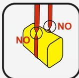
\* Las eslingas usadas en forma de "U" deberán estar balanceadas para evitar deslizamiento de la carga. Se deben evitar torceduras o retorcimiento en la eslinga.
