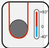
\* **Temperatura:** Los productos sintéticos convencionales nunca deberán ser usados en temperaturas por encima de 93°. En temperaturas por debajo de 40° no afecta la capacidad de carga del producto. Si el producto es usado fuera de los rangos aceptados, deberá ser considerado y evaluado por el usuario.
