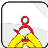
\* Cualquier tipo de accesorio como grilletes o ganchos, deberán ser inspeccionados en búsqueda de defectos o rebabas filosas que puedan dañar la eslinga. Todas las cargas aplicadas a un gancho de izaje deberán estar centradas en el cuerpo del gancho para evitar izajes con la punta. El uso de accesorios y/o materiales no adecuados podría ocasionar un grave accidente.
