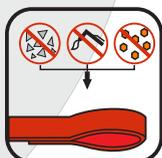
\* **Materiales dañinos:** Astillas de metal, soldadura, arenas gruesas, pueden dañar interiormente y exteriormente una eslinga.
