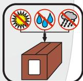
\* **Almacenaje:** Cuando no sean utilizadas, deberán ser almacenadas en un lugar fresco, seco y de preferencia oscuro. El lugar de almacenaje deberá estar ventilado y no expuesto a calor o rayos solares.
